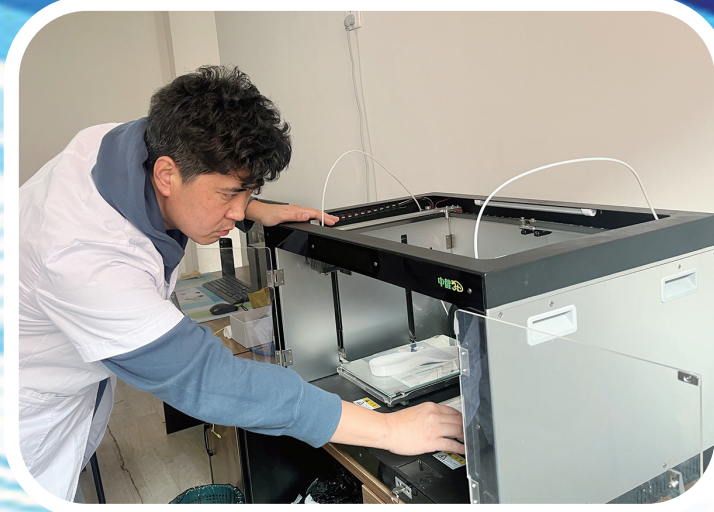
长春中健利衡医药科技有限公司工作人员正在操作3D打印机制作3D打印矫形鞋垫
