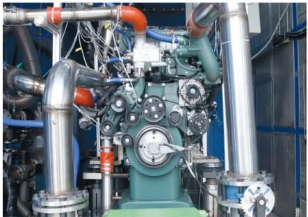
一汽解放自主研发的国内首款重型商用车缸内直喷氢气发动机成功点火。
