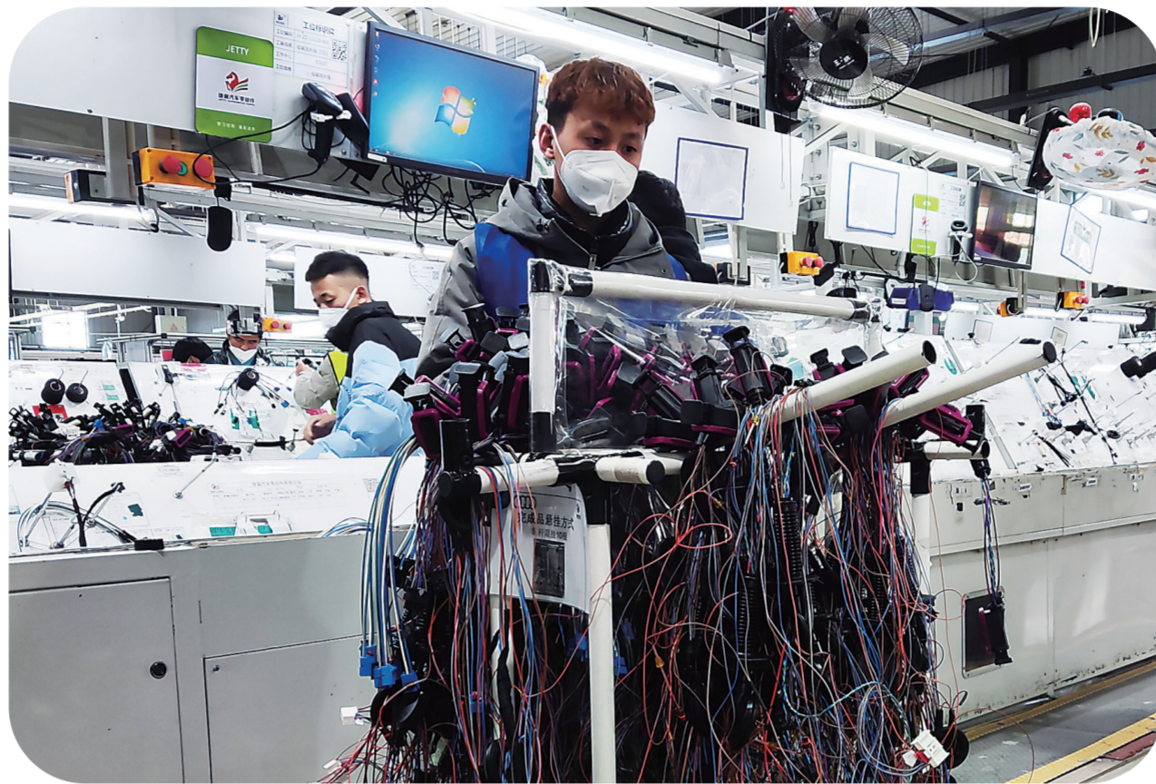
长春捷翼汽车零部件有限公司车间内，工人正在整理线束产品。
