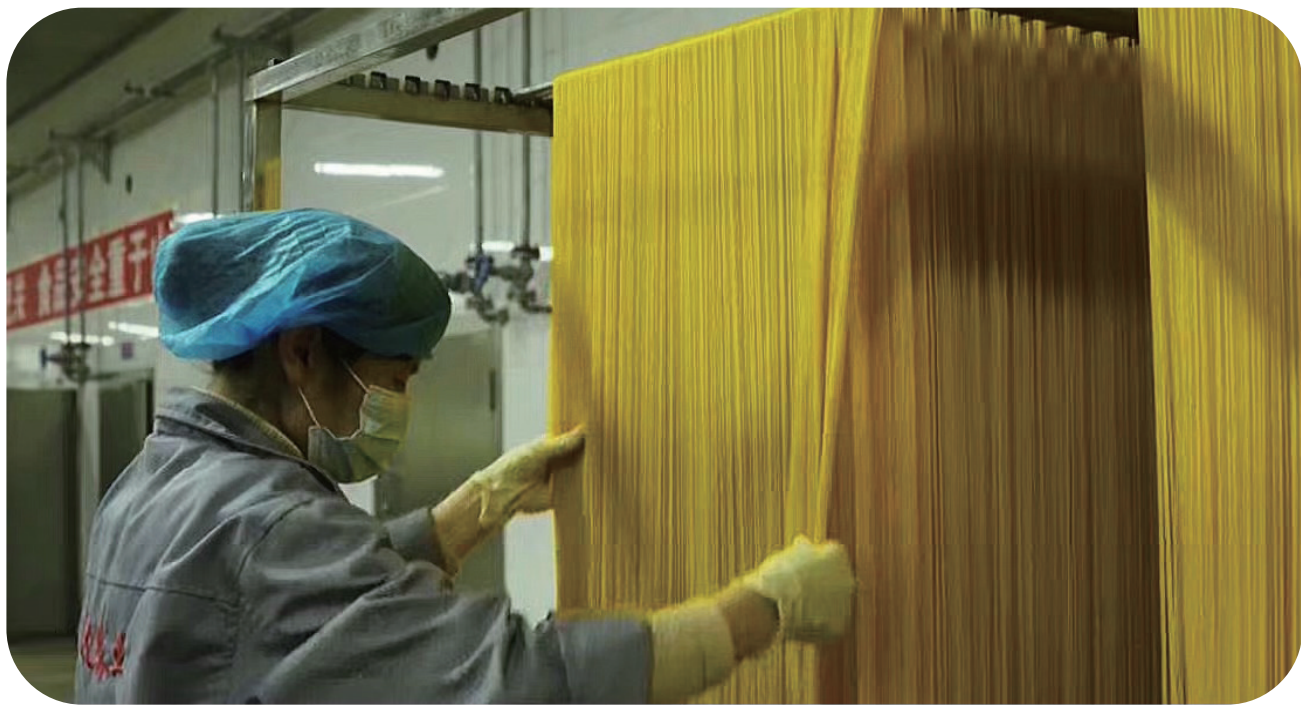
公主岭市健亿农业综合开发有限公司玉米杂粮面条生产加工车间内，金黄的玉米通过自动生产线熟化后，晾晒成可口的杂粮面条。(资料图片)
