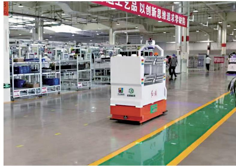
大众物流自主研发无人AGV在一汽红旗动力总成工厂配送作业。
