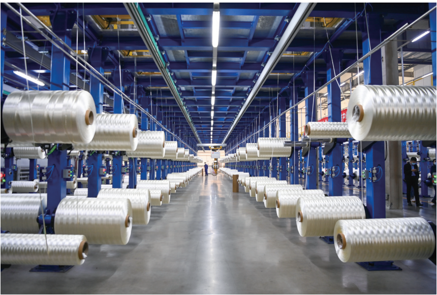
在吉林化纤集团国兴碳纤维公司生产车间,工人在整理碳纤维原丝(2022年10月31日摄)。
