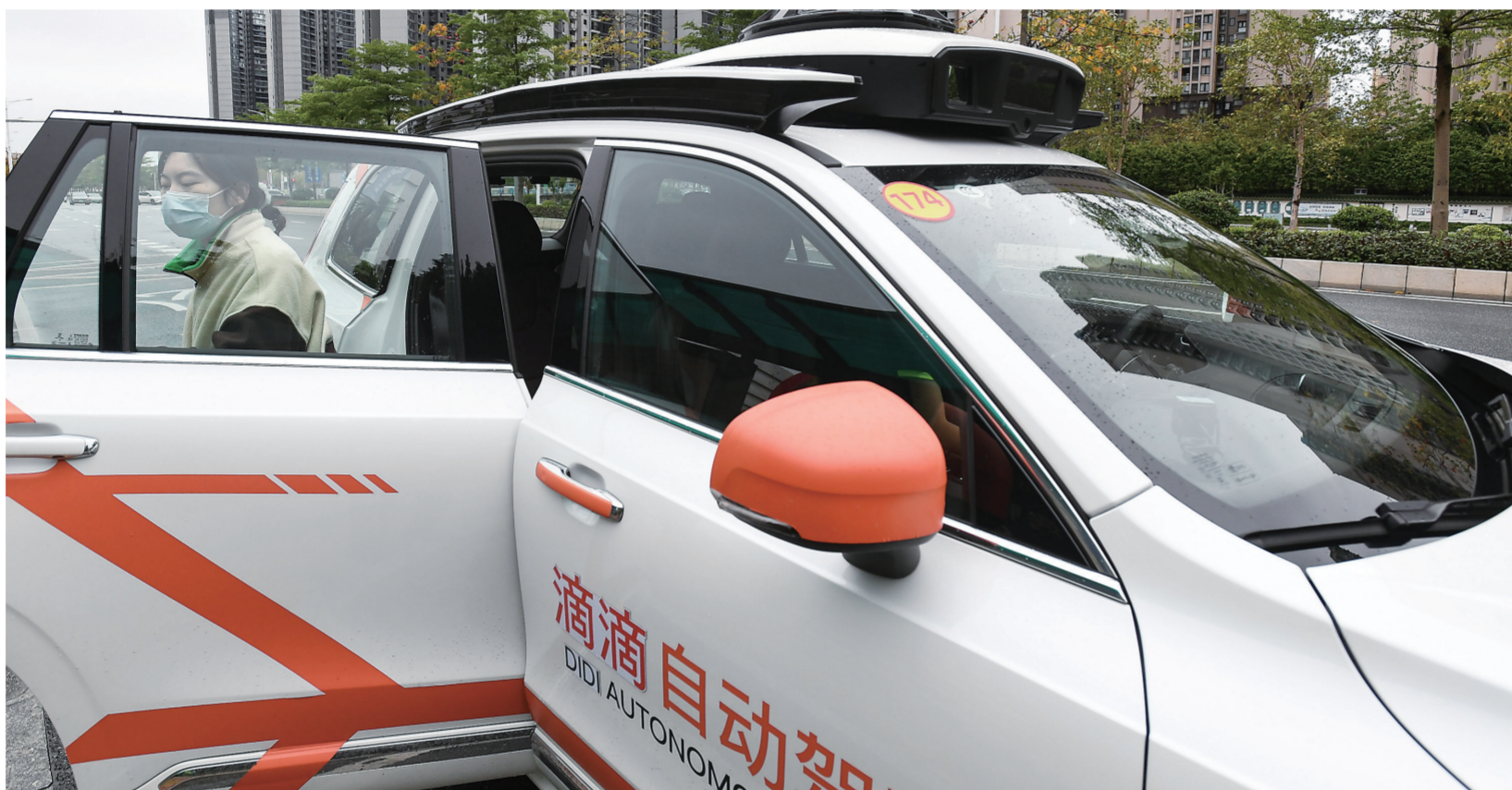
滴滴自动驾驶车辆配备了远、中、近激光雷达、多个中焦距摄像头以及红外相机等传感器(3月27日摄)。
