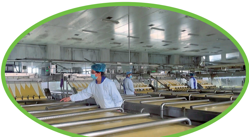
在白山市裕达特产科技有限公司的生产车间里，一颗颗饱满的黄豆经过研磨、蒸煮、压制、风干等多道工序，变成了一张张厚薄均匀的豆皮、干豆腐，再经过切割、冷冻等工序后，通过冷链运输发往全国各地。
