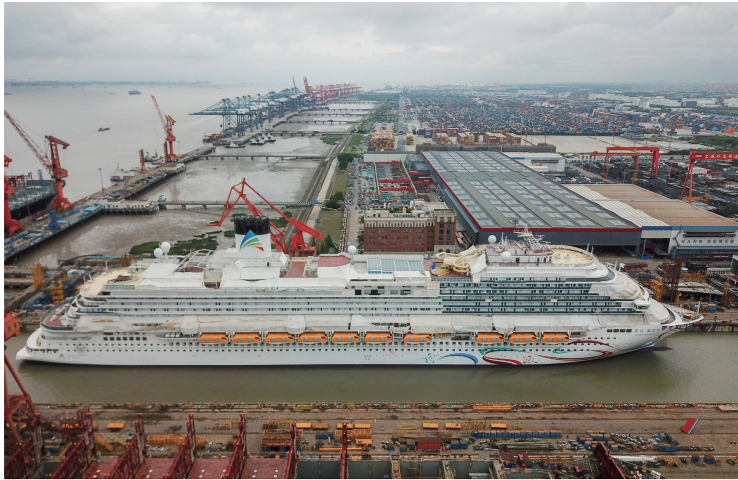
这是6月6日拍摄的首艘国产大型邮轮“爱达·魔都号”(无人机照片)。当日,由中国船舶外高桥造船有限公司建造的首艘国产大型邮轮“爱达·魔都号”出坞,标志着国产大型邮轮项目全面转入码头系泊调试阶段,预计将于今年年底完工交付。新华社记者丁丁摄
