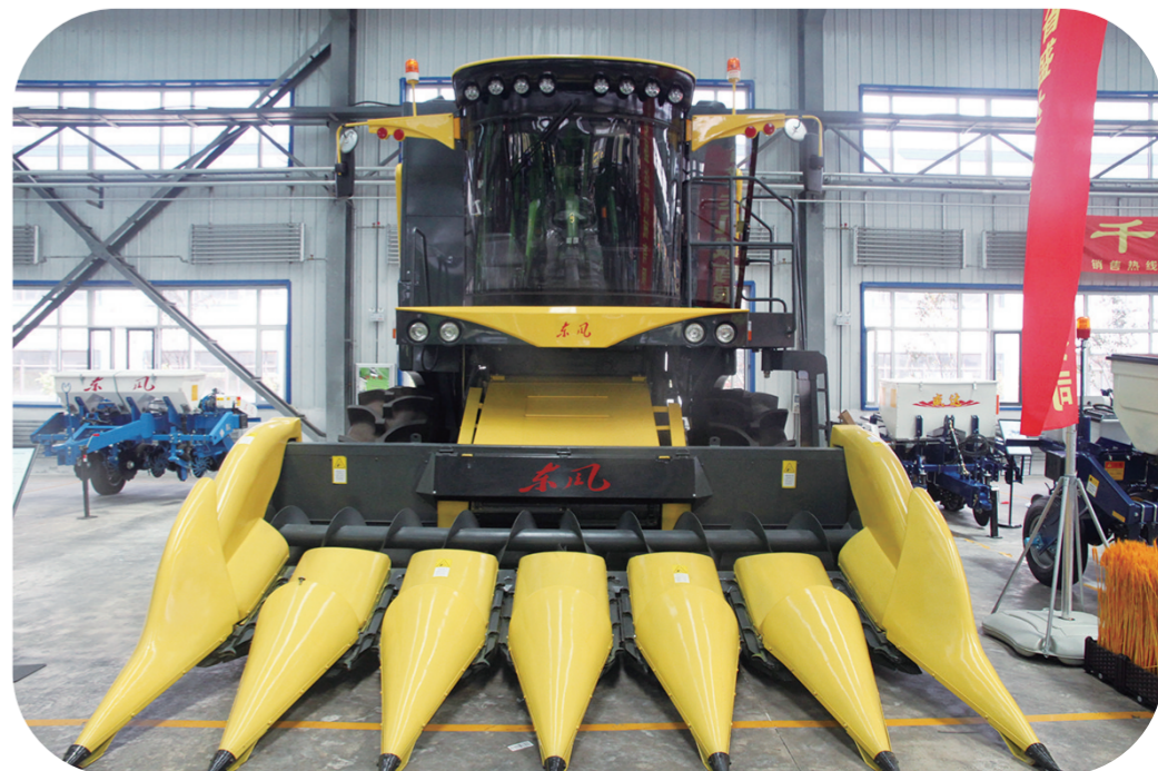
四平东风联合收割机有限公司生产的2000型自走式玉米收获机。袁松年 摄
