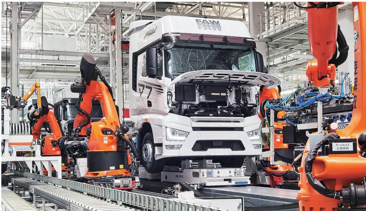
一汽解放J7整车智能工厂采用国际先进制造及检测技术的同时,充分结合主流的数字化技术,以工业互联网平台为核心载体,实现汽车工业与物联网、大数据、云计算等新建技术成果的充分融合,打造了个性化定制、网络化协同的智能制造新模式。图为机械臂正在为解放J7重卡安装轮胎。
