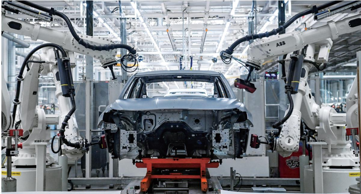
在一汽红旗繁荣工厂焊装车间内，焊装机器人在生产线上焊接车身(2022年10月17日摄)。近年来，中国一汽从创新入手，以科技赋能，着力提升生产效率，一批高智能化、高自动化的新型工厂顺利投产。在智能化的生产车间内，无数智能机器人有条不紊地按照行程轨迹进行工作，冲压、焊装、涂装、总装……各生产工序中都有智能机器人的身影，部分流水线上的自动化率已达到100%。流水线上各式各样机器人“新伙伴”的加入，不仅让生产效率和产品质量得以双双跃升，也使得传统汽车制造业在新一代智能信息技术的深度融合中走上高质量发展新路子。
