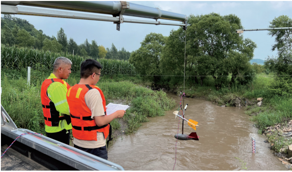
磐石汶水河孟家水资源监测站工作人员正在测流。
