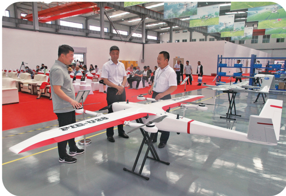
四平航天宏图无人机有限公司生产的PIE-U28垂直起降固定翼无人机。高鸿 摄
