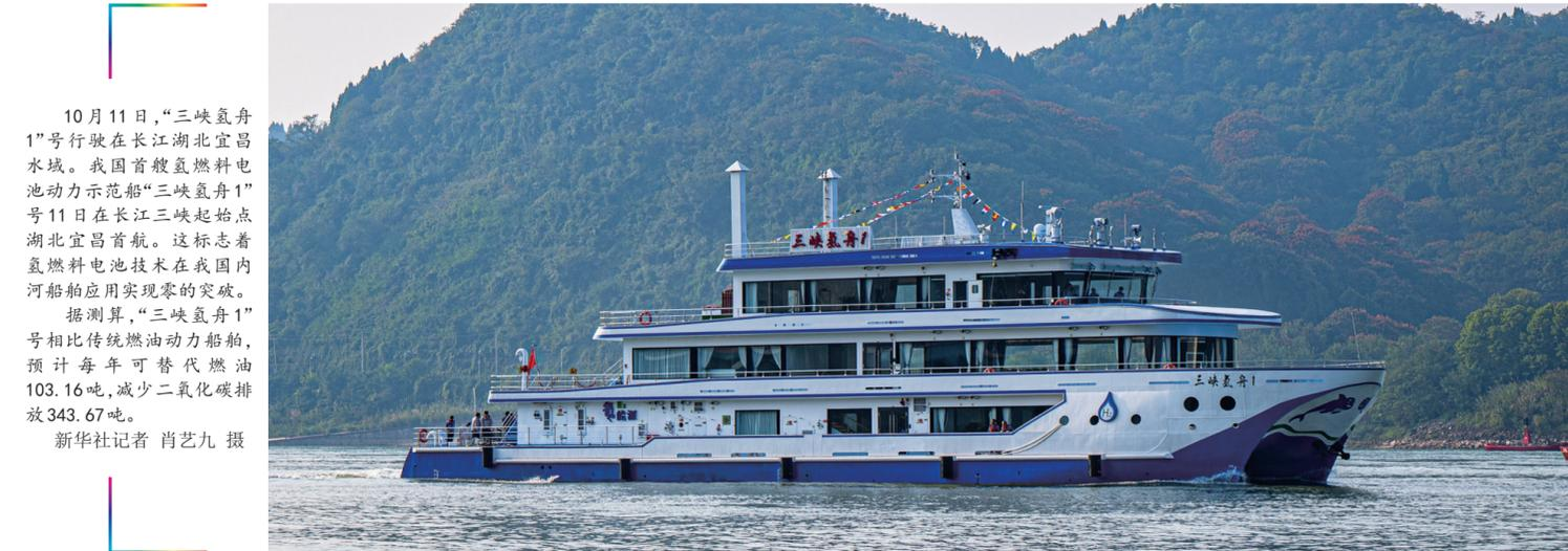
10月11日,“三峡氢舟1”号行驶在长江湖北宜昌水域。我国首艘氢燃料电池动力示范船“三峡氢舟1”号11日在长江三峡起始点湖北宜昌首航。这标志着氢燃料电池技术在我国内河船舶应用实现零的突破。
