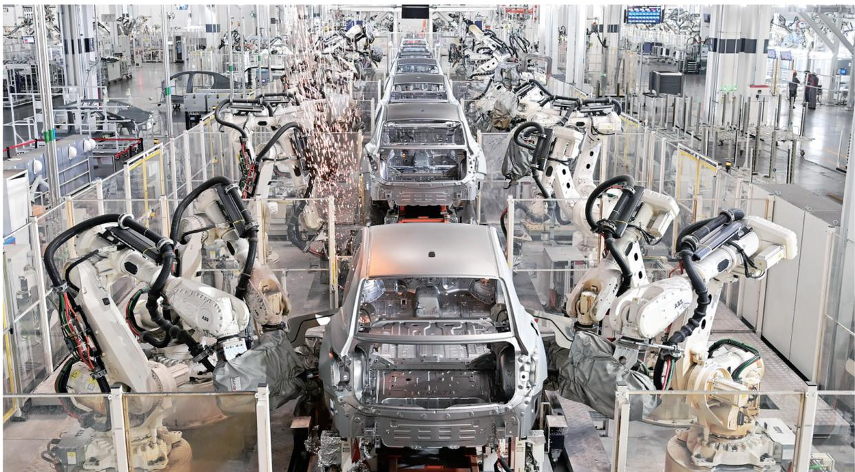
中国一汽全力推动红旗品牌数智化转型，在一汽红旗繁荣工厂，高端、智能、绿色的自动化生产线，有效提升了生产效率和产品品质。图为智能机器人在生产线上按照行程轨迹工作。苑激刚 本报记者 石雷 摄
