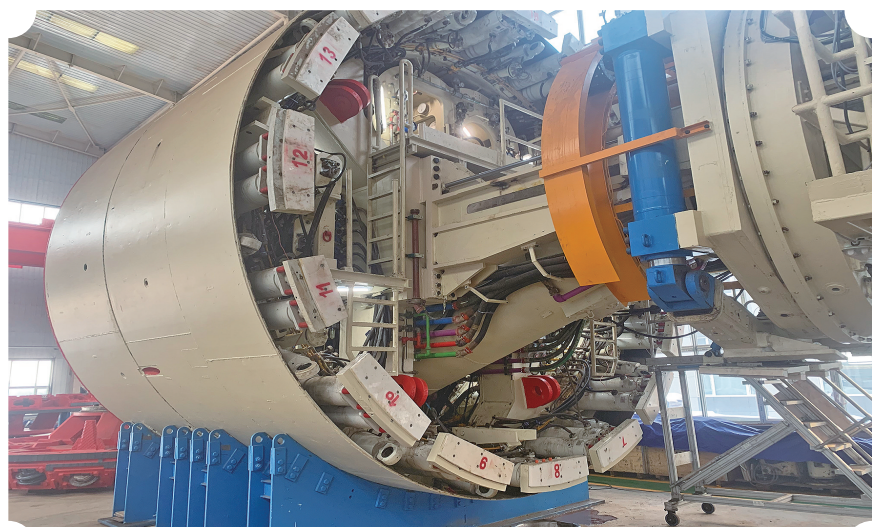
工人正在对一台刀头直径为6.4米的盾构机进行维修保养。
