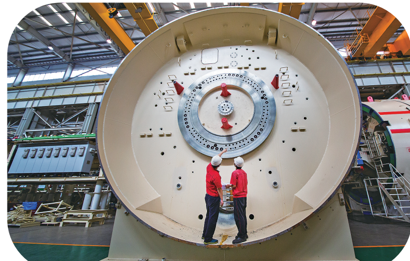
在给盾构机安装刀盘前，技术人员在盾体内部进行最后检查。
