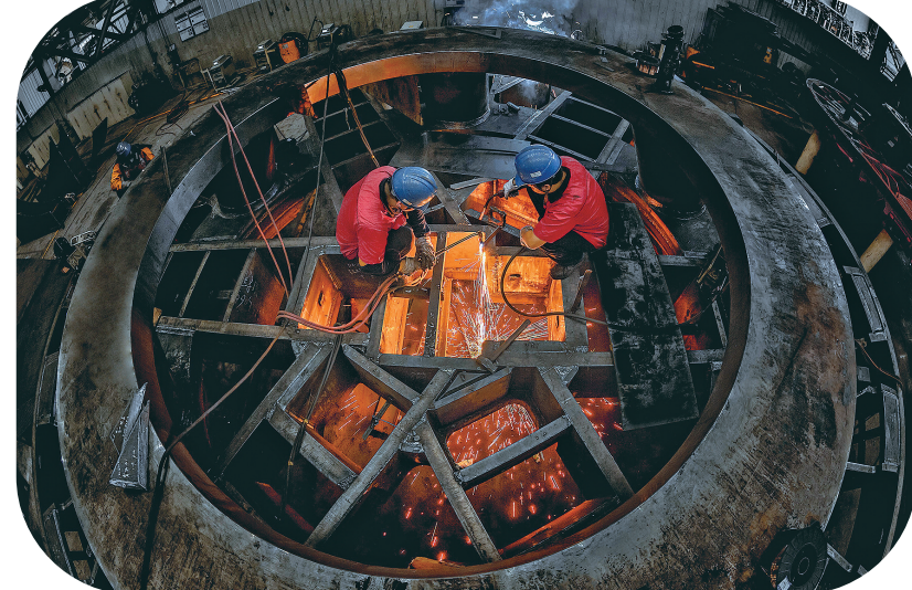
长春铁建重工焊工工人正在对盾构机刀盘加工。
