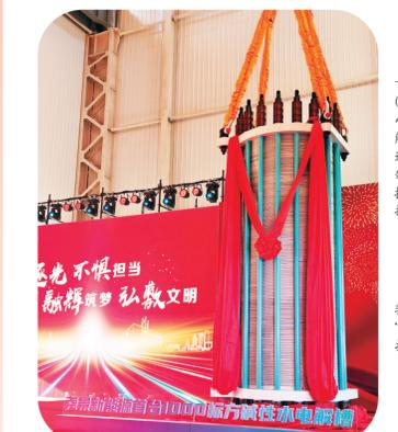
◀吉林省首台1000Nm³/h(标准立方米每小时)碱性水电解制氢装置,为打造新能源装备制造产业集群提供了重要支撑。
