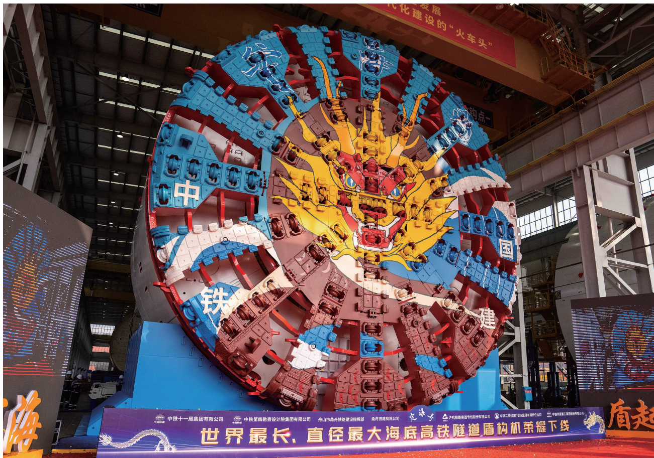
这是1月10号在铁建重工长沙第一产业园拍摄的“定海号”超大直径盾构机。当日，由中铁十一局和铁建重工联合打造的超大直径盾构机“定海号”在长沙顺利下线，其最大开挖直径14.57米，总重量达4350吨，将投用于世界最长的海底高铁隧道——甬舟铁路金塘海底隧道建设。
