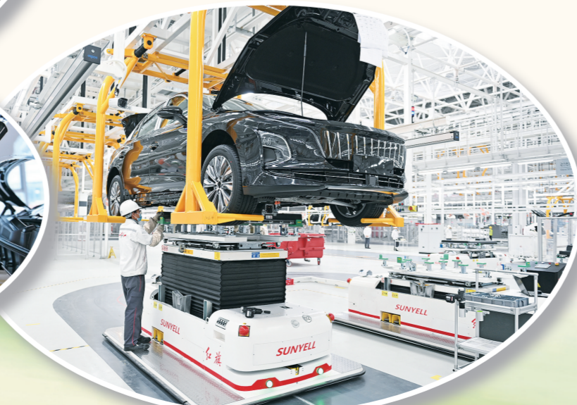
新能源汽车动力电池安装现场。
