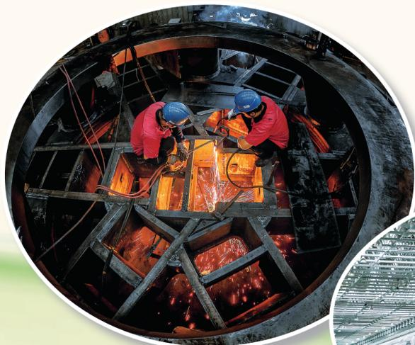
长春铁建重工铆焊工人正在进行盾构机刀盘加工。
