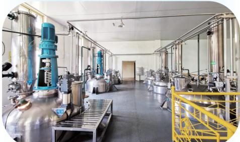
通化华夏药业采用先进的计算机自动化控制技术进行中药提取、浓缩及药液精制等生产。李铭 摄
