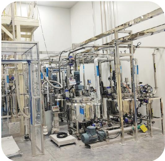
固态电池协同创新公共平台建设任务项目装料高速分散系统。
