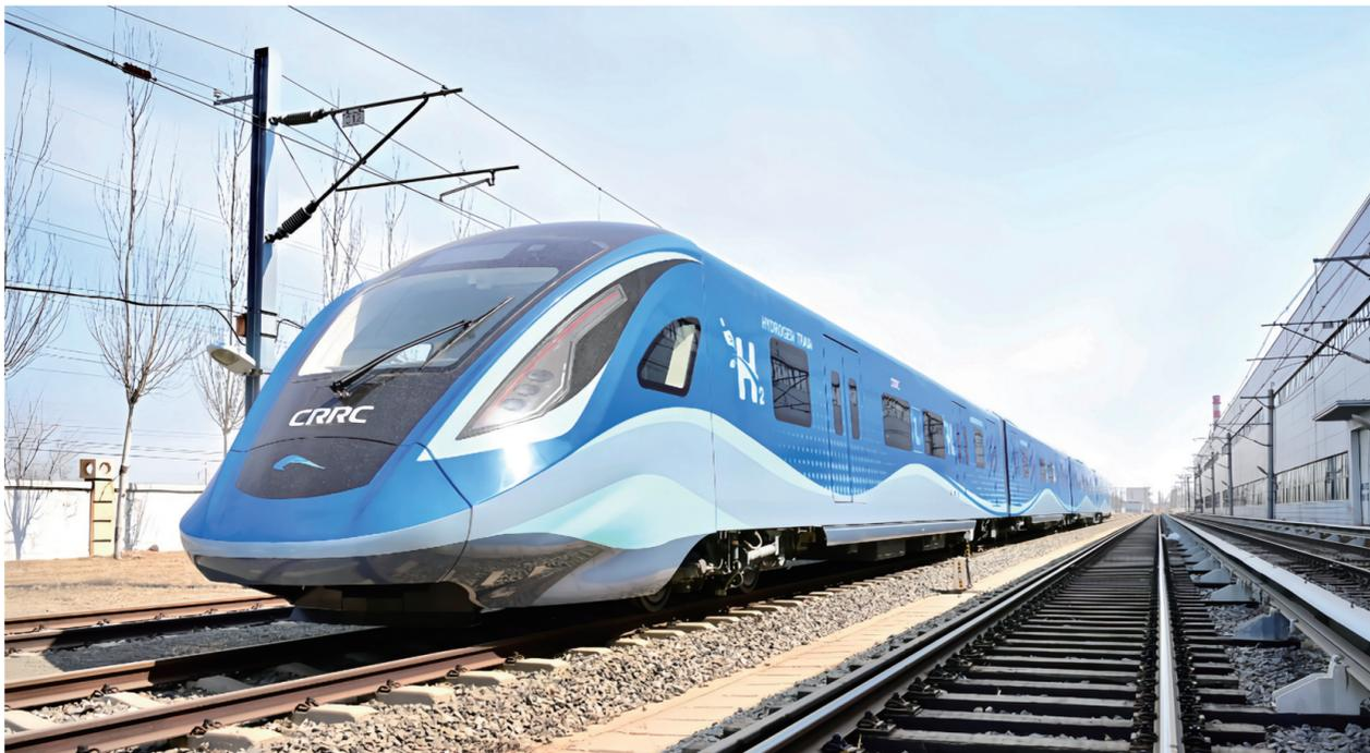
4月3日，在中车长客股份有限公司列车调试场地上，全球首列氢能市域列车正在进行调试试验。由中车长客股份有限公司自主研发的全球首列氢能市域列车在近日完成了时速160公里的达速试验，不仅标志着氢能在我国轨道交通领域迎来了又一次重大突破，同时也验证了我省扎实的科技创新与大装备制造能力，更是我省新质生产力加速形成的最新生动实践。
