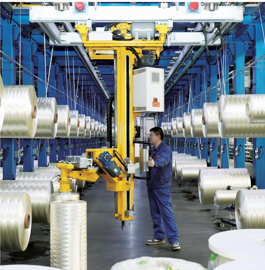
吉林化纤不断加大产品研发力度，目前已形成了大丝束通用化、高品质、低成本的产业优势及小丝束专业化、高性能、高精尖技术优势，开辟了新的碳纤维工艺路线，产业链关键核心技术实现了自主可控。图为吉林化纤碳纤维生产现场，工人正在进行换筒操作。
