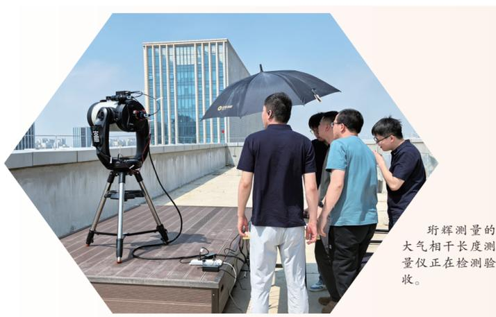
珩辉测量的大气相干长度测量仪正在检测验收。
