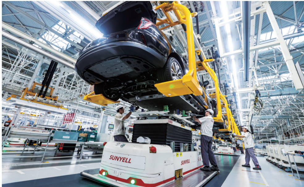
多年来,中国一汽勇担产业使命,坚持创新驱动,累计突破高效高速电驱、智能线控底盘等数百项关键核心技术。这是在一汽红旗繁荣工厂总装车间,工人正在进行电池合装作业。
