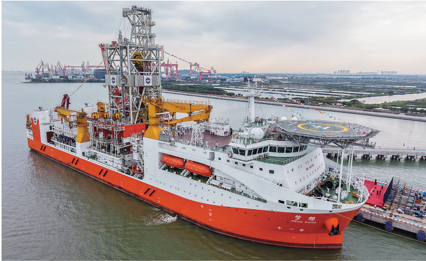
11月17日拍摄的靠泊在广州海洋地质调查局科考码头的大洋钻探船“梦想”号(无人机照片)。当日,拥有最大11000米的钻深能力、我国自主设计建造的首艘大洋钻探船“梦想”号在广州正式入列,标志着我国深海探测关键技术装备取得重大突破。
