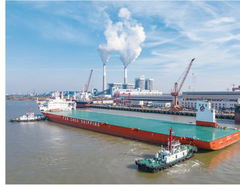
12月22日，“泛洲8”轮准备靠泊在泰州众航船厂码头(无人机照片)。当日，大型自航甲板船“泛洲8”轮从上海以东水域进行为期5天的各种专业航海测试后回港。“泛洲8”轮总长256米，型宽51米，型深13米，最大载重量58405.4吨，续航可达16000海里，最大航速超过15节(约27.78公里/小时)。
