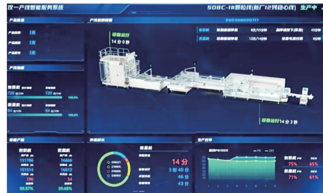
包装生产线生产运行状态与数字监控画面。
