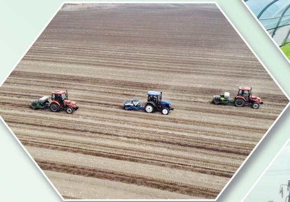
在梨树县，几台新型多功能免耕播种机在广袤的大地上来回穿梭，秸秆处理、深松、整地、开沟、施肥、播种、覆土、镇压等工序一气呵成，奏响了一曲充满希望的春耕乐章。（梨树县委宣传部供图）
