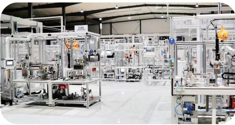
▲吉林世宝转向管柱自动装配生产线。
