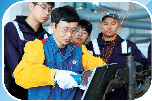
师傅正在示范用砂轮打磨机件。
