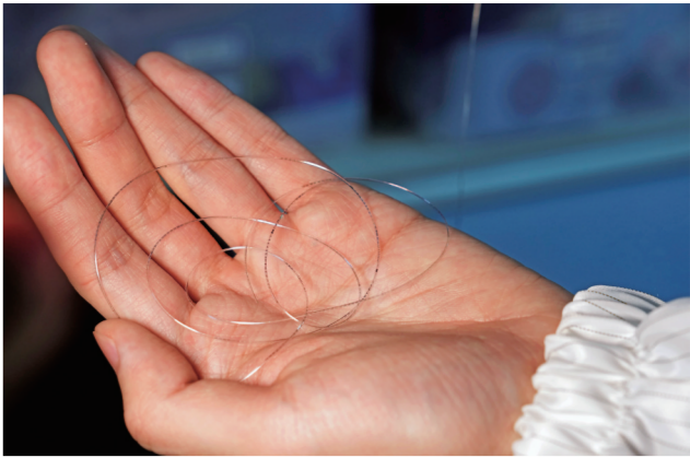
这是1月19日在复旦大学纤维电子材料与器件研究院拍摄的“纤维芯片”。记者从复旦大学获悉,该校科研人员通过设计新型架构,率先在柔软、弹性的高分子纤维内实现了大规模集成电路,把“纤维芯片”从概念变为现实。相关成果1月22日发表于《自然》杂志。 新华社记者 刘颖 摄
