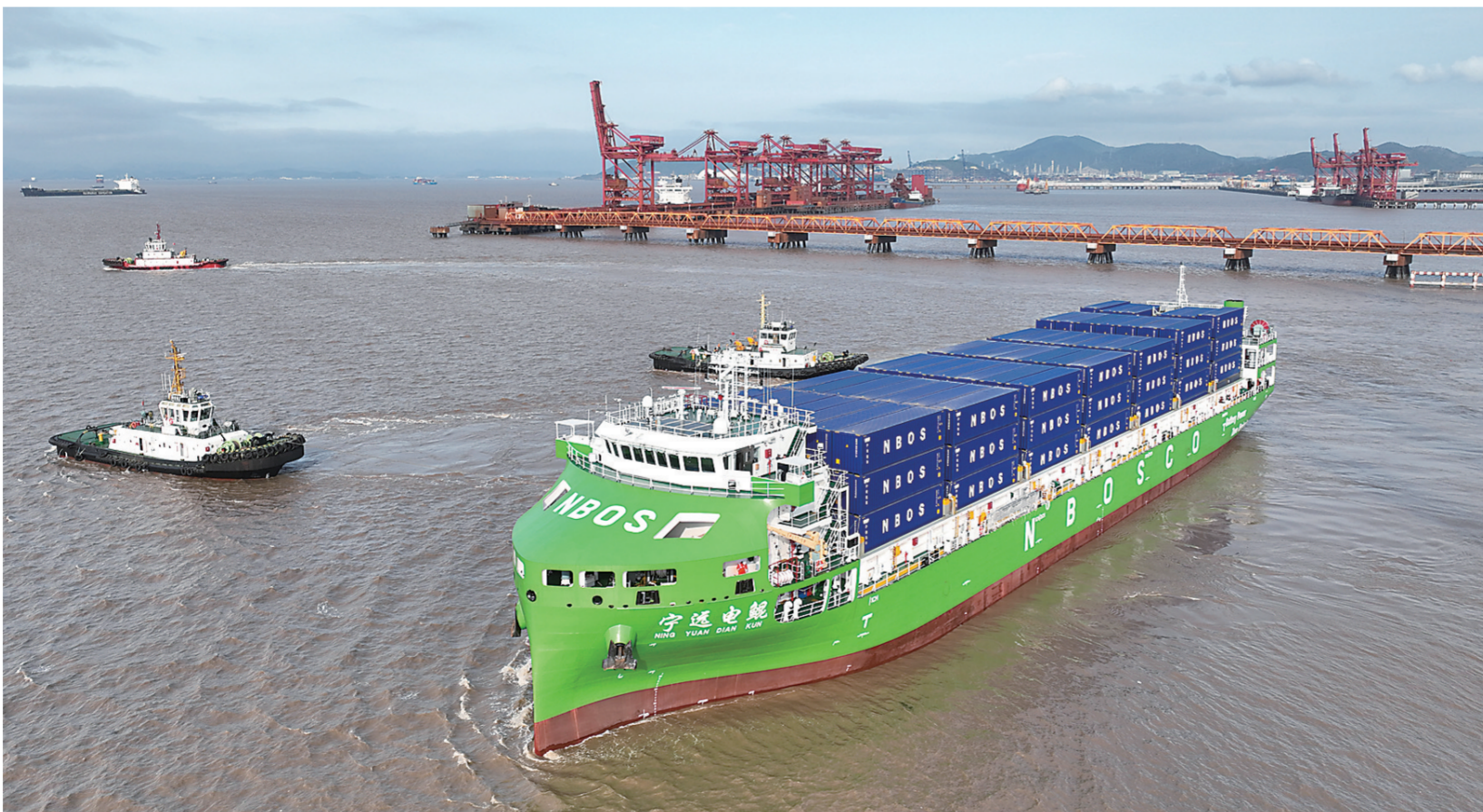
远电“宁海”轮从宁波舟山港北仑港区启航，驶向嘉兴港乍浦港区(无人机照片)。4月15日，全球最大、国内首艘万吨级纯电动智能集装箱海船“远电”轮从宁波舟山港北仑港区启航，驶向嘉兴港乍浦港区，标志着该船正式投入商业航线运营。 新华社发
