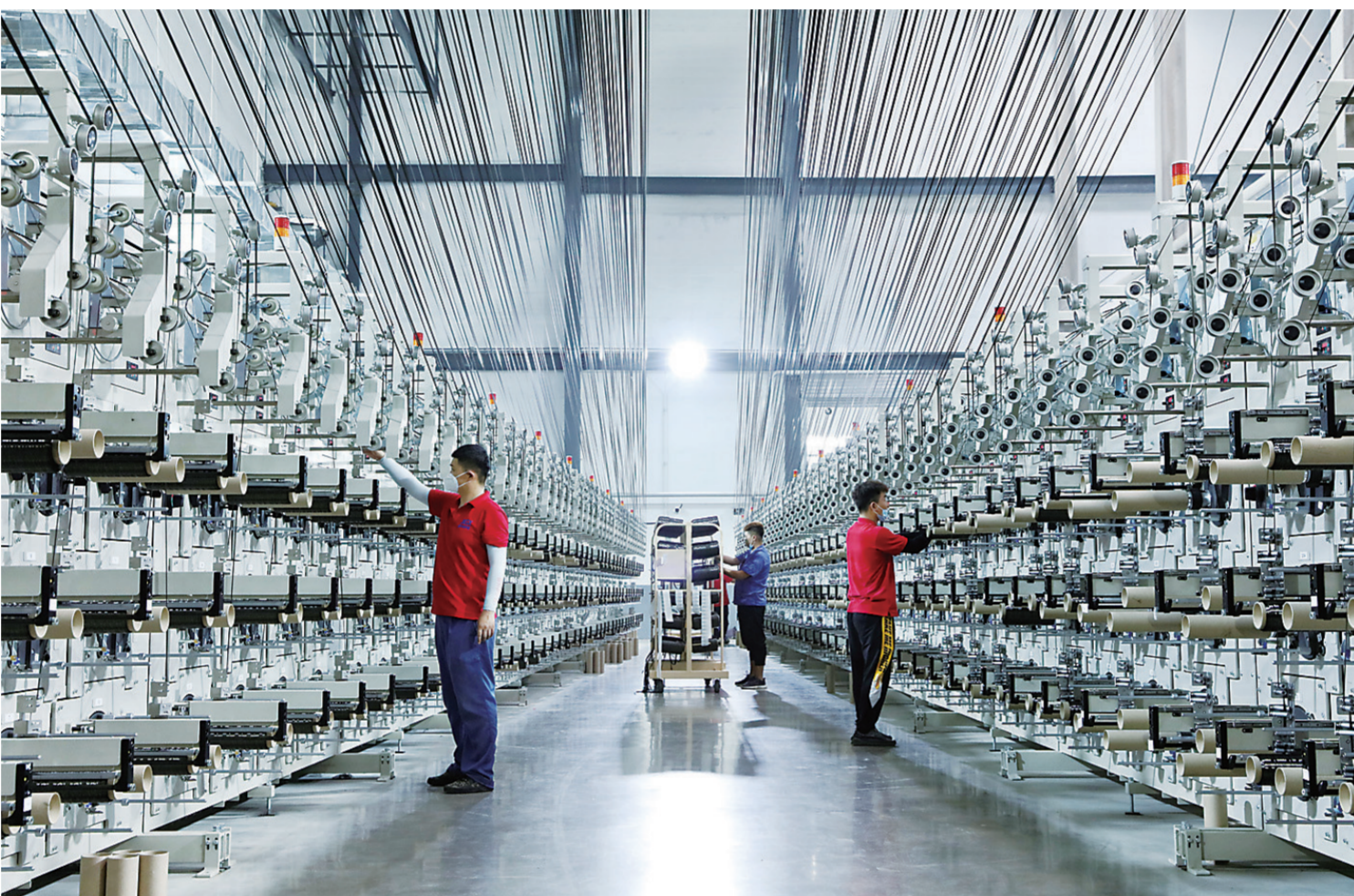
吉林化纤集团年产4000吨大丝束碳纤维生产现场。
